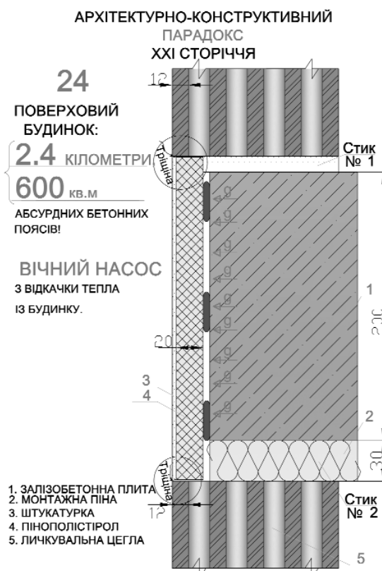
Рис. 3. Вузол стику стіни з перекриттям
